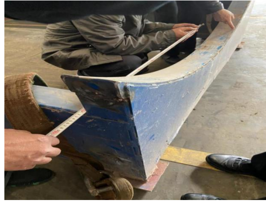
图 2 测量罐底座划痕尺寸
