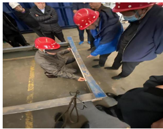
图 4 测量罐底座与罐顶部长方形槽垂直尺寸
