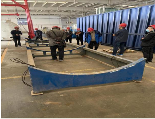
图 1 罐底座现场实物图
