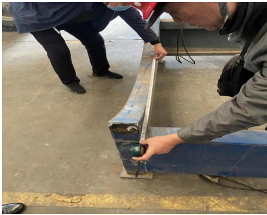
图 3 测量罐底座中心尺寸
